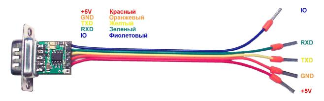
Выводы конвертора подключаются к одноименным выводам контролера.
